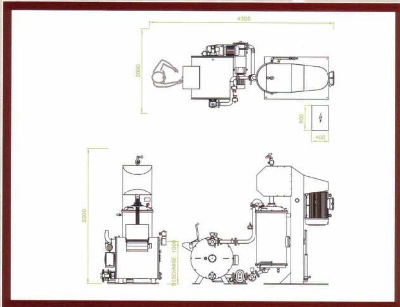
Le broyeur à billes type CAO B2000 a été spécialement conçue pour le mélange, l'affinage et le conchage du chocolat, des produits d'enrobage et des pâtes à tartiner.
